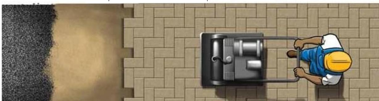
A compactação das bordas do pavimento, bem como de locais de difícil acesso às placas vibratórias (como a compactação junto a construções) deve ser realizada utilizando equipamentos de menor porte.
